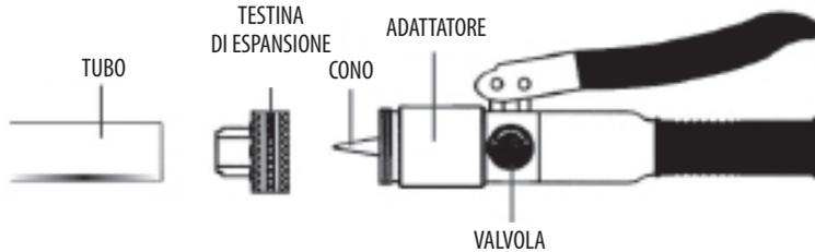
Si può usare con tubi in rame, alluminio titanio fine, per ottenere forme allargate senza intaccare le pareti delle tubazioni. Opera facilmente e velocemente.
