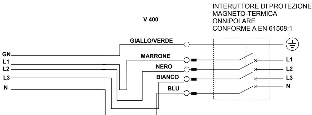
NOTA: è necessario collegare il disgiuntore termico, dei motori elettrici ad un sistema ausiliario di interruzione trifase esterno.
