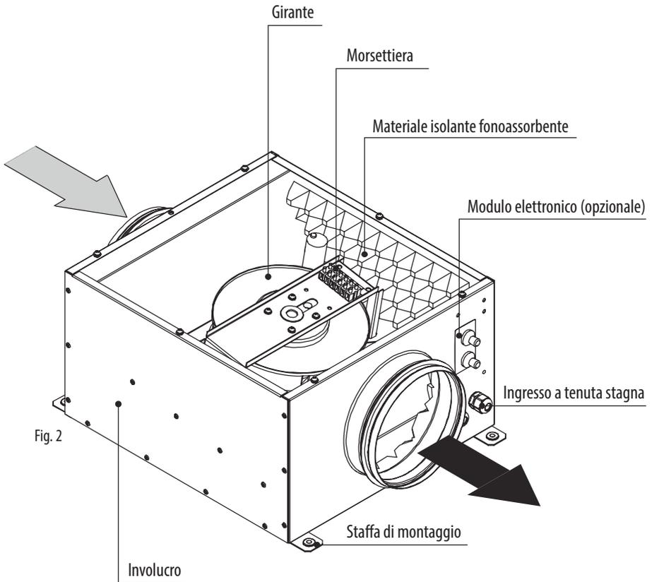
L'involucro della ventola è realizzato in lamine di acciaio zincato con strati aggiuntivi per isolamento termico e sonoro. Gli attacchi rotondi sono dotati di guarnizioni in gomma (vedi Fig. 2).
