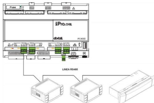
Per collegare i dispositivi da controllare è possibile utilizzare due cavi schermati da 0,5 mm<sup>2</sup>. Utilizzare l'ingresso di massa solo per problemi di comunicazione.
