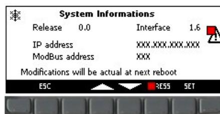
Nella schermata illustrata in figura sono indicati l'indirizzo ModBus, l'indirizzo IP del dispositivo di controllo (necessario per l'attivazione del datalogger online), la versione software e il software installato sulla tastiera.
