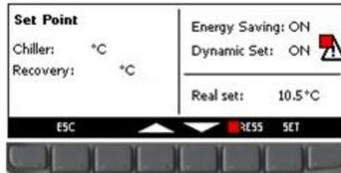
In questo menu è possibile impostare il setpoint bassa temperatura **"Chiller"** (Refrigeratore) e il setpoint alta temperatura **"Recovery"** (Recupero).
