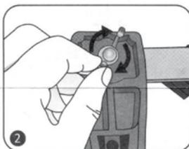
2 Posizionare la barra sulla scanalatura della piegatrice e chiudere la vite a farfalla sul fondo della piegatrice
