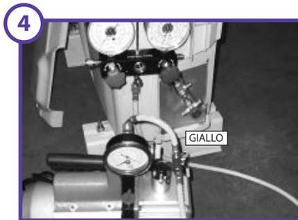
Collegare il tubo flessibile giallo dalla parte del rubinetto a sfera all'attacco della pompa del vuoto. Collegare l'altro capo del tubo flessibile giallo all'attacco di carica (centrale) del gruppo monometrico.
