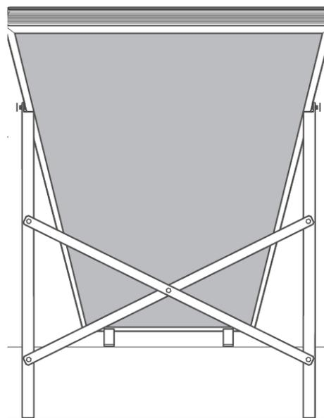
Per consentire la successiva installazione del collettore è necessario che le due barre verticali E siano disposte con i lati interni rivolti verso il pannello.
