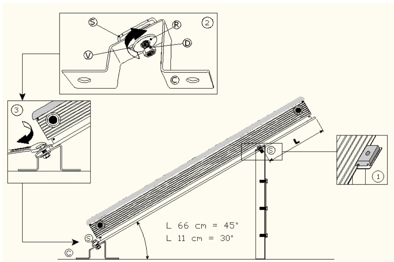
Nel disegno precedente sono indicati in modo chiaro i tre passaggi necessari per procedere al montaggio del collettore.
