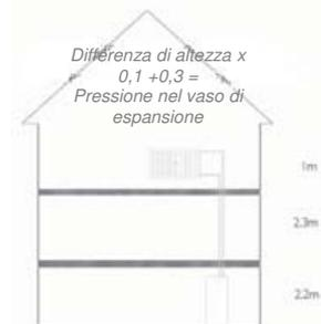
Esempio: Se il serbatoio si trova al piano terreno e i radiatori all'ultimo piano, la differenza di altezza tra il vaso di espansione e i radiatori sarà di circa 5,5 m.
