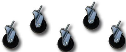
Ogni ruota è attrezzata con freno. Le ruote sono 5 in totale: 1 per ogni piede e 1 per il palo centrale telescopico. Per il montaggio su piedi registrabili: levare la gomma di ogni piede e avvitare direttamente la ruota sulla base. Per il montaggio della ruota centrale (palo telescopico): avvitare le 2 viti a disposizione, e svitare leggermente la vite della molla per agganciarci al supporto.
