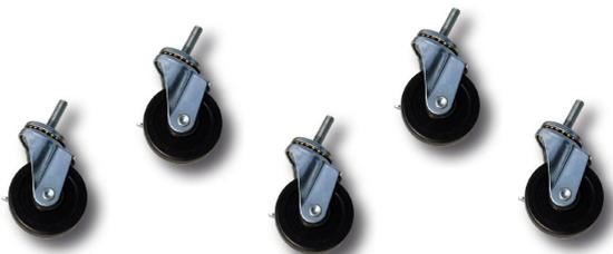
Ogni ruota è attrezzata con freno. Le ruote sono 5 in totale: 1 per ogni piede e 1 per il palo centrale telescopico. Per il montaggio su piedi regolabili: levare la gomma di ogni piede e avvitare direttamente la ruota sulla base. Per il montaggio della ruota centrale (palo telescopico): avvitare le 2 viti a disposizione, e svitare leggermente la vite della molla per agganciarsi al supporto.
